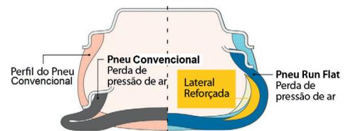
Esta característica confere ao pneu uma elevada rigidez que se traduz não só numa drástica redução do conforto do veículo, como numa diminuição evidente do tempo de vida de molas, amortecedores e outros elementos da suspensão. Assim, os construtores de veículos passaram a incluir este tipo de pneu como opcional do equipamento de origem, permitindo-lhes adaptar as respetivas suspensões às características do pneu runflat.
