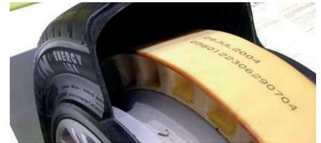
Como facilmente se percebe pelas descrições destas tecnologias, a montagem e desmontagem do pneu e do anel interior de apoio da jante não são tarefa fácil. Estas soluções trouxeram a necessidade de equipamentos específicos para as operações de montagem e desmontagem do pneu na jante.
