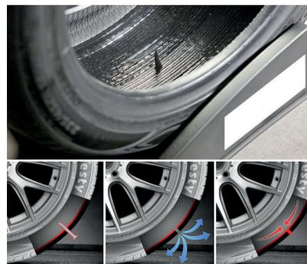
Mesmo que o objeto que originou o furo seja retirado, a substância vai preencher o furo e manter a vedação do pneu, desde que seja de dimensões reduzidas (cerca de 5mm, podendo ter variações de fabricante para fabricante).
