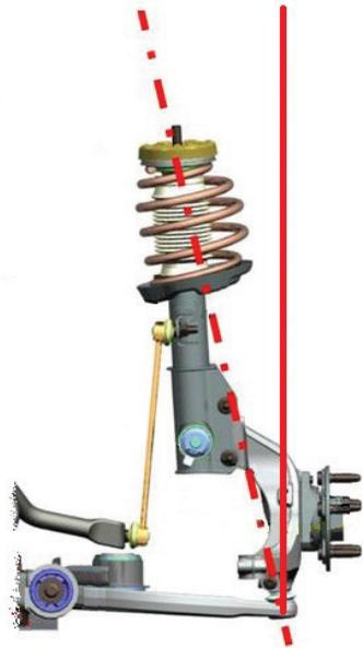
**Função** Proporciona estabilidade direcional; Reduz o esforço sobre os componentes; Permite o retorno do volante à posição de andamento a direito.
