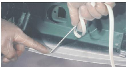
Na reparação de carroçarias podem apresentar-se de variadas maneiras de acordo com a sua aplicação: em tubos ou cartuchos para aplicar com pistola pneumática ou manual, em latas, para aplicação à trincha ou em cordão vedante, para colocação direta à mão.
