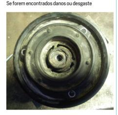
Substitua o compressor de ar condicionado
