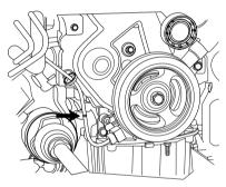
Retire a braçadeira Repare os condutores eléctricos Monte uma nova braçadeira Prenda a cablagem, conforme a necessidade
