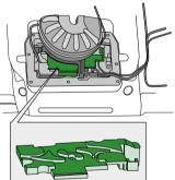
Tempo de reparação Substitua a bateria (OE: 86.15.01.02) 0.4# Monte as bases de borracha (OE: 05.10.50) Monte a braçadeira (OE: 05.10.50) 0.5# Peças necessárias Bateria LR033179 Base da bateria: LR055670 Braçadeira: LR055390 Kit de calço: LR056022
