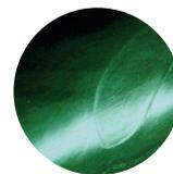
As crateras, muitas vezes denominadas olhos de peixe, são depressões em forma de cratera, com rebordos salientes. São causados por contaminação com silicónes, limpeza deficiente da superfície do substrato ou contaminação da linha de ar comprimido.
