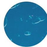
O aparecimento, após a demão final, de marcas da reparação sob a forma de círculos em torno de áreas reparadas pode ter na sua origem diversos fatores. Alguns deles são: bizelagens do resalto mal efetuadas, secagem do aparelho incompleta antes da aplicação de nova camada, superfície de suporte não se encontrar devidamente curada ou a aplicação do material de preparação foi realizada em camadas demasiado espessas.
