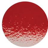
A corrosão pode ser outro defeito na pintura que se caracteriza pelo aparecimento de ferrugem sob a camada de tinta. Surge quando riscos da superfície não foram atempadamente retificados, as gravilhas estão combinadas com contaminantes da estrada e humidade ou simplesmente por uma má preparação da superfície.
