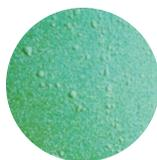
A formação de bolhas corresponde a pequenos pontos de empolamento na superfície. Este defeito pode surgir porque a superfície de base absorveu humidade, ou porque a humidade do ar, antes da pintura, estava demasiado elevada.
