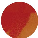
Nos acabamentos metalizados podem surgir pontos que sobressaem da camada de tinta. Este defeito pode ser causado pelo pigmento da formulação estar contaminado, ou em mau estado. Pode ser corrigido lixando levemente com abrasivos finos a zona afetada, após a secagem da camada de verniz, limpar, desengordurar e repintar a superfície intervençcionada.
