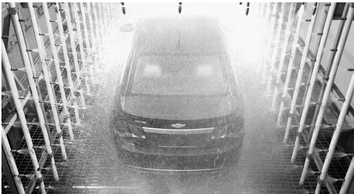
sição ou substituição da proteção da cava da roda mal posicionada ou deteriorada. Se não houver entrada de água, significa que não existe problema de estanqueidade na cava da roda traseira e então dever-se-á proceder à aspersão do painel traseiro e dos faróis.
