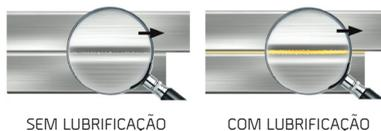
O atrito entre duas superfícies secas deve ser evitado durante o trabalho de qualquer componente mecânico. Provoca grandes perdas de energia mecânica, acentuado desgaste, calor excessivo e fenómenos de gripagem, colocando fora de serviço os componentes em movimento.
