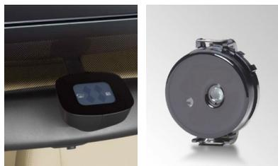
O sensor, apesar de não conter um elevado número de componentes, é complexo. No seu interior encontramos um diodo emissor de luz (LED – Light Emitting Diode) que envia um pulso ultravioleta ou infravermelho em curtos intervalos de tempo (aproximadamente 40 milissegundos). Nos sistemas mais antigos, esta luz era refletida numa lente instalada no para-brisas. Na segunda geração, o sensor de chuva deixou de apresentar a lente, sendo a luz refletida
