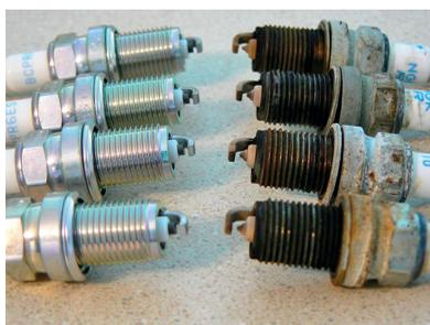
O diagnóstico ao estado das velas de ignição que são removidas de um motor podem ajudar a determinar se o motor tem problemas que precisam ser corrigidos. Várias situações podem ocorrer das quais, entre outras, se podem destacar as seguintes:
